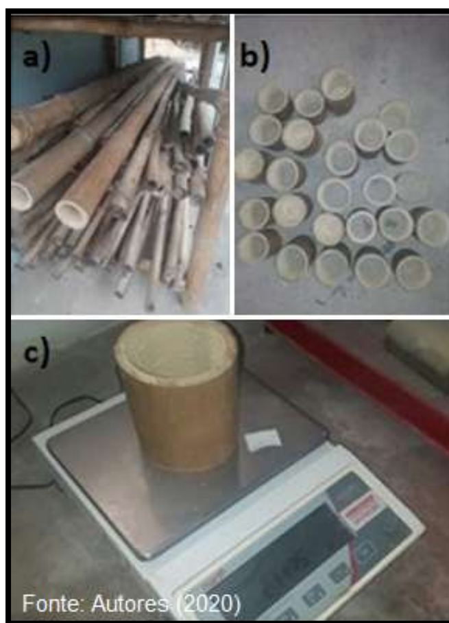
Figura 5 – a) bambus em secagem b) bambus cortados em anéis c) anel de bambu sendo pesado
